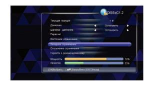
**Пересчет:** Нажмите кнопку ОК, чтобы показать окно пересчета. Затем выберите «ДА» и нажмите кнопку ОК, чтобы заново вычислить другие спутниковые позиции согласно текущему положению спутника, или нажмите «ВЫХОД» и нажмите кнопку ОК, чтобы отменить операцию.
